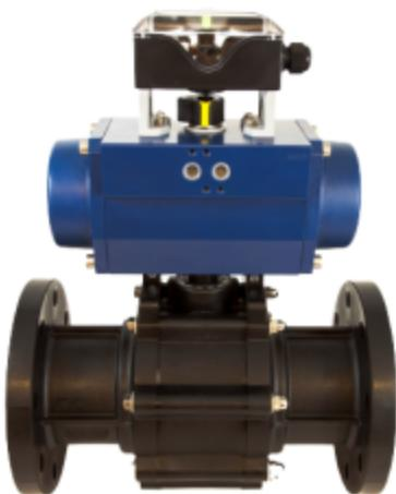
(二) 气动调节阀由气动执行机构和调节阀两部分组成。气动执行机构以无油压缩空气为动力，接受气信号 20~100kpa 并转换成位移，驱动调节阀以调节流体的流量。为了改善阀门位置的线性度，克服阀杆的摩擦力和消除被调介质压力变化等的影响，提高动作速度，使用气动阀门定位器与调节阀配套，从而使阀门位置能按调节信号实现正确的定位。气源质量应无明显的油蒸汽、油和其他液体，无明显的腐蚀气体、蒸汽和溶剂。带定位器的调节阀气源中所含固体微粒数量应小于 0.1g/m<sup>3</sup>,且微粒执行应小于 60μm 含油量应小于 10g/m<sup>3</sup>。
